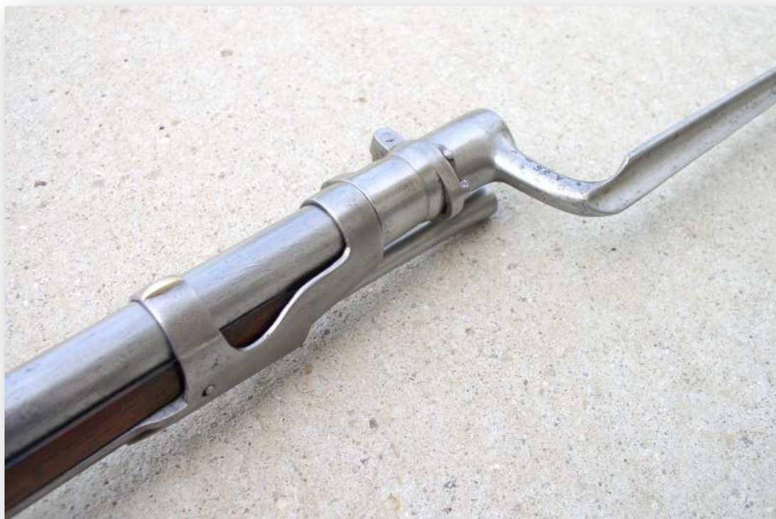
Les organes de visée du fusil *Charleville* modèle 1777, « corrigé An IX » sont très sommaires. Au bout du canon, se trouve un **guidon**, simple repère métallique (ici en laiton) placé sous le haut de l'**embouchoir**, pièce métallique qui entoure l'extrémité du canon et permet de rendre ce dernier solidaire du bois de l'arme. Sous l'embouchoir, on distingue la **baguette** qui sert à tasser la poudre lors du chargement. À l'extrémité du canon vient se placer la baïonnette.
